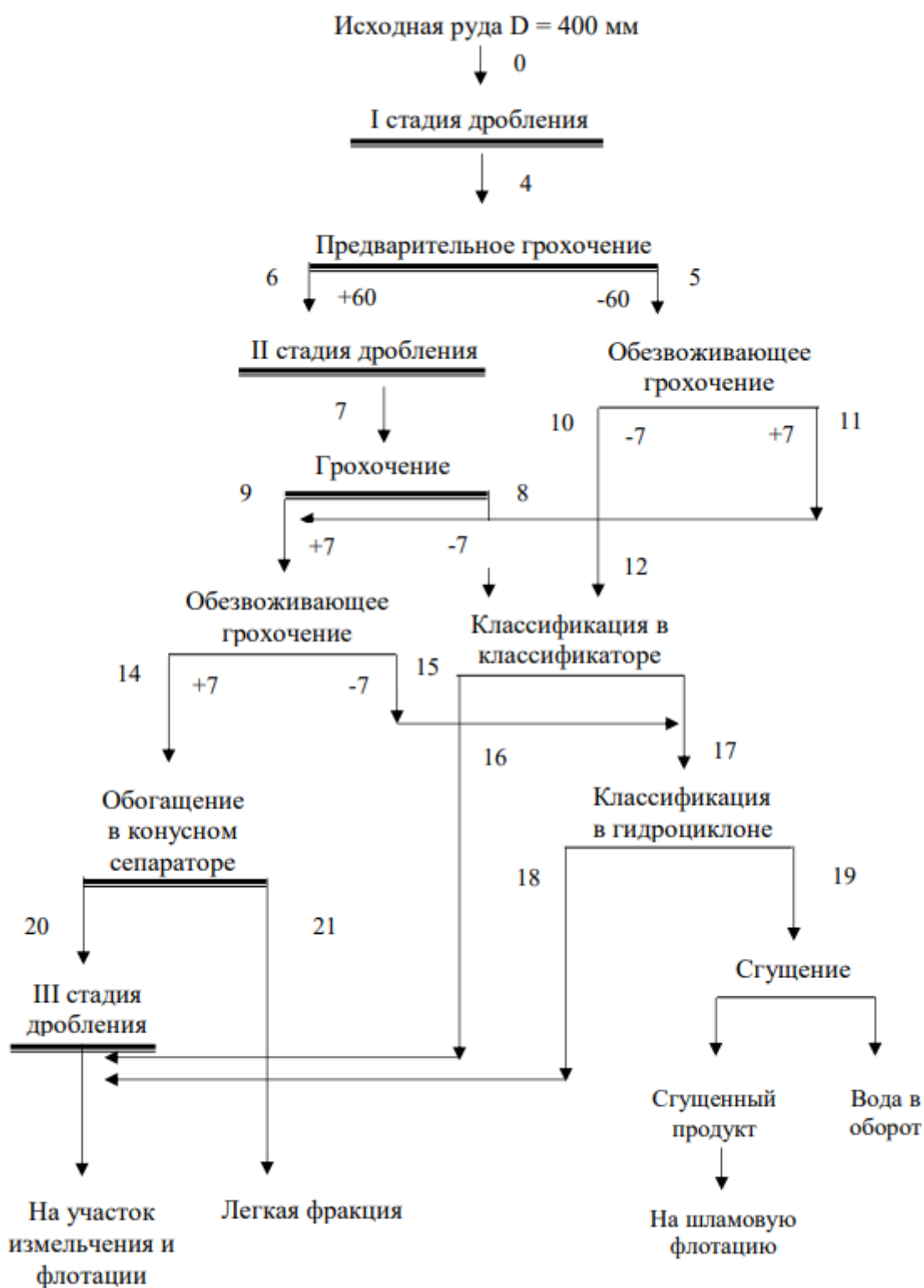
Рисунок 5 – Схема дробления и предобогащения
